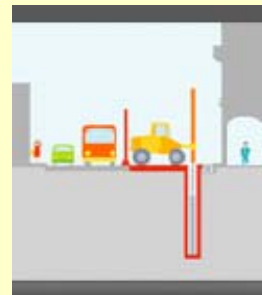
palificazioni per pareti laterali scavo
