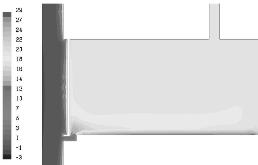
Figura 12 – Distribuzione delle temperature [C] in inverno
